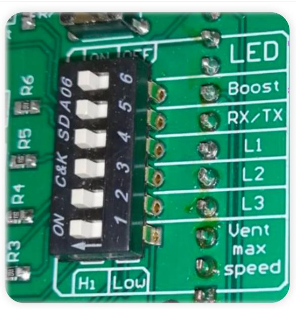
Jednotka je vybavena možností vypnout svit jakékoliv indikační LED diody posunutím páčky do polohy ON/OFF. U položky „Vent max speed“ lze zakázat maximální otáčky ventilátoru, ten pak bude provozován na cca 40 % výkonu a prakticky bezhluchně.
